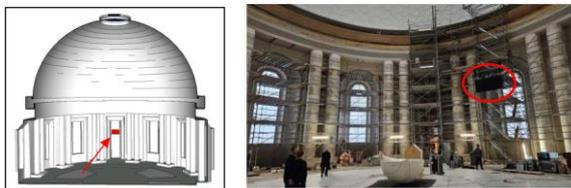
Abbildung 6: geplante Anordnung des Matrixlautsprechers und Probebeschallung (mit geringfügig anderer Position des Lautsprechers als in der Planung)
